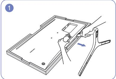
Положите на пол защитный пенопластовый материал (стирофом), входящий в комплект, и разместите на нем устройство экраном вниз, как показано на рисунке. При отсутствии защитного материала используйте толстый коврик.
