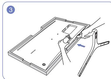
Положите на пол защитный пенопластовый материал (стирофон), входящий в комплект, и разместите на нем устройство экраном вниз, как показано на рисунке. При отсутствии защитного материала используйте толстый коврик. Удерживайте заднюю часть монитора, как показано на рисунке. Вставьте собранную подставку в корпус в направлении стрелки, как показано на рисунке.
