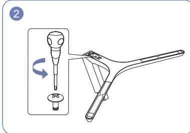
Открутите соединительный винт в нижней части подставки.
