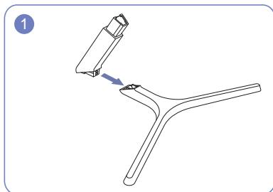
Вставьте соединительный элемент в подставку, как показано на рисунке. Проверьте, надежно ли закреплен соединительный элемент подставки.
