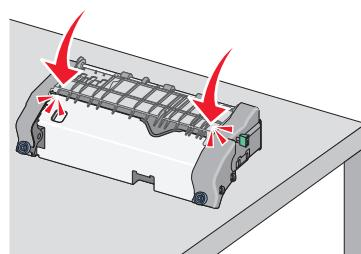
**И** Чтобы освободить верхнюю направляющую для бумаги, вытащите и поверните зеленую прямоугольную ручку против часовой стрелки.
