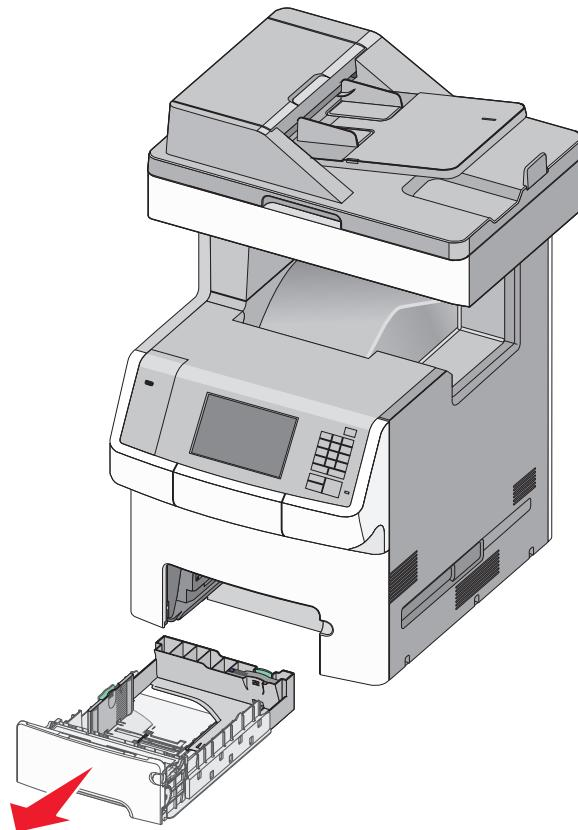
**2** Сожмите, а затем передвиньте направляющую ширины в положение, соответствующее формату загружаемой бумаги.
