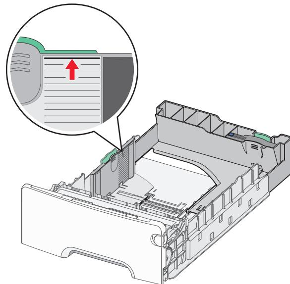
**ПРЕДУПРЕЖДЕНИЕ. Возможность повреждения:** Загрузка слишком большого количества бумаги может привести к замятиям бумаги и возможному повреждению принтера.
