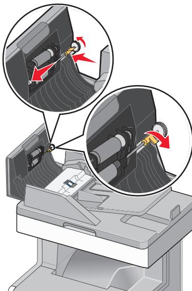
**7** протрите всю поверхность под крышкой устройства автоматической подачи, включая два небольших белых валика.
