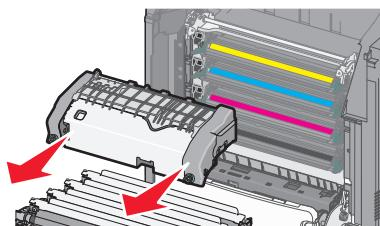
**Г** Положите термоблок на плоскую поверхность так, чтобы винты с синими накатными головками были обращены к вам.
