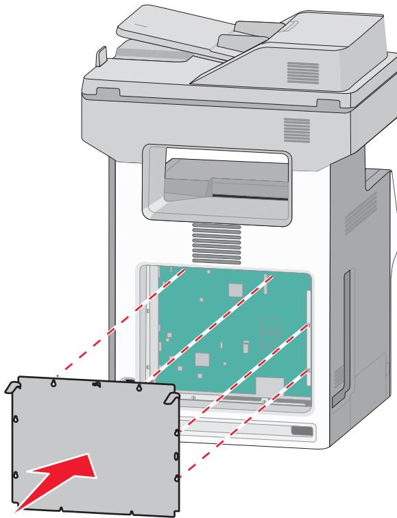
**б** Сдвиньте крышку вниз, а затем поверните каждый винт по часовой стрелке, чтобы затянуть его.
