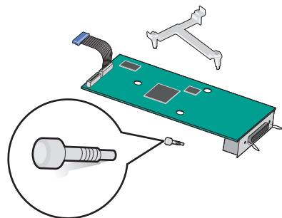
**6** Подсоедините интерфейсный кабель решения ISP к гнезду на системной плате, имеющему цветовую кодировку.
