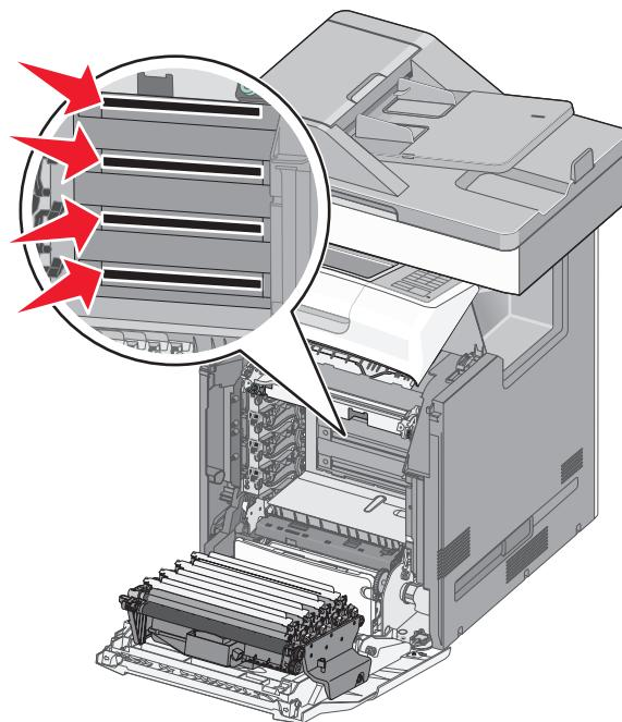
**4** Очистите линзы с помощью баллона со сжатым воздухом.
