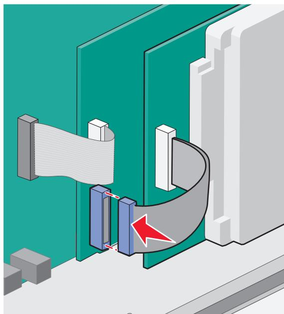
**Чтобы установить жесткий диск принтера непосредственно в системную плату:**
