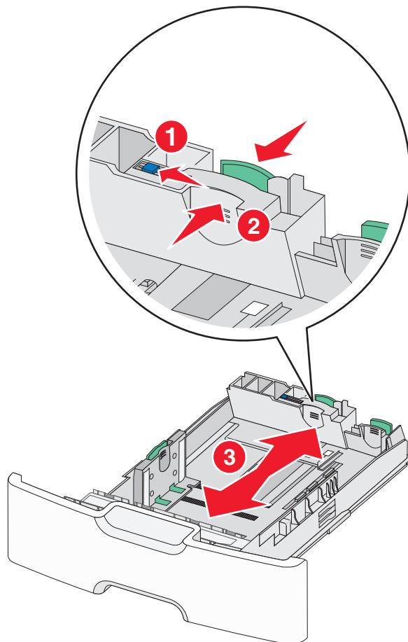
**3** Сожмите, а затем передвиньте направляющую ширины в положение, соответствующее формату загружаемой бумаги.
