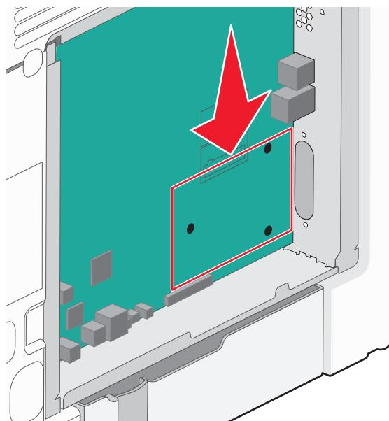
**Примечание.** Если установлен дополнительный порт ISP, то жесткий диск принтера необходимо установить в порт ISP.
