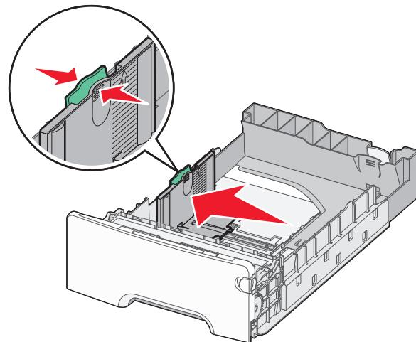
**Примечание.** Для установки направляющих длины и ширины используйте индикаторы формата внизу лотка.
