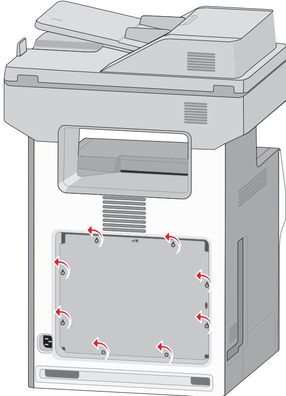
**6** Слегка сдвиньте крышку вверх, чтобы каждый винт попал в отверстие.
