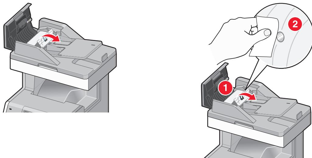
4 Закройте клапан, а затем закройте крышку устройства автоматической подачи.
