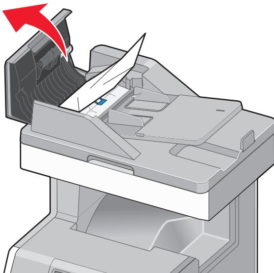
**3** Закройте крышку устройства автоматической подачи.
