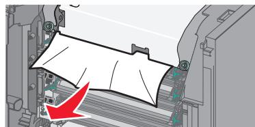
6 Если замятая бумага видна над направляющей в узле термоблока, возьмитесь за замятую бумагу и осторожно вытащите ее.
