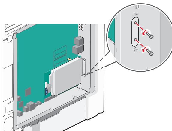
4 Извлеките жесткий диск принтера, потянув его вверх, чтобы отсоединить выступы.
