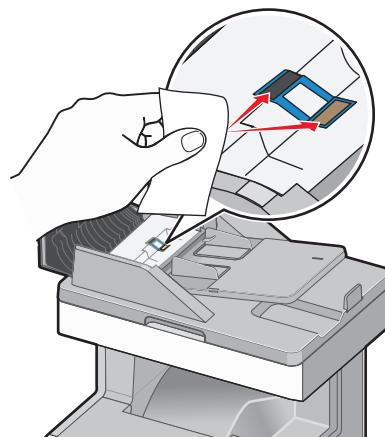
**9** Потяните клапан вверх, как показано на рисунке, а затем протрите находящийся за ним датчик.
