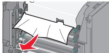
б Если замятая бумага видна над направляющей в узле термоблока, возьмитесь за замятую бумагу и осторожно вытащите ее.
