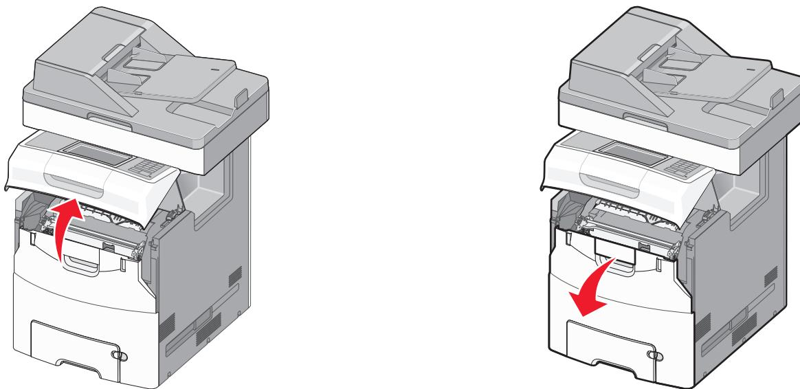
**ПРЕДУПРЕЖДЕНИЕ. Возможность повреждения:** Для предотвращения повреждения блоков фотопроводника под воздействием света не оставляйте переднюю дверцу открытой дольше, чем на 10 минут.
