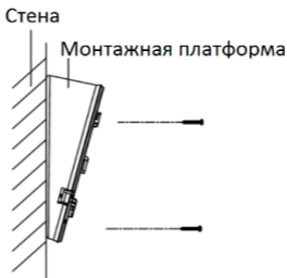
Рисунок 2-8 Установка наклонной монтажной платформы
