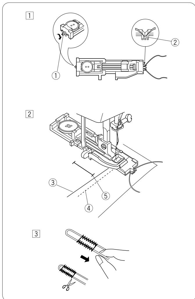
1 Поднимите лапку для автоматической петли, набросьте шнур на крючок сзади лапки. Переведите концы шнура вперед, заправив под лапку. Зацепите шнур в вилке впереди лапки, чтобы натянуть его.
