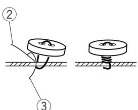
Удалите нить из иглы. Измените ширину зигзага так, чтобы игла сквозь прорезь на лапке попадала в отверстия пуговицы. Поверните маховое колесо и проверьте, входит ли игла в отверстия пуговицы. Опустите прижимную лапку, чтобы закрепить пуговицу на месте. Отверстия в пуговице должны совпадать с прорезью на лапке.
