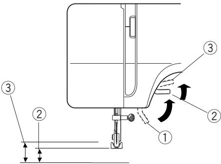
Рычаг подъема прижимной лапки поднимает и опускает прижимную лапку.
