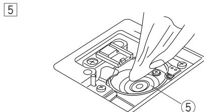
1 Снимите прижимную лапку и иглу. При помощи отвертки удалите винт игольной пластины. Снимите игольную пластину и вытащите шпульку.
