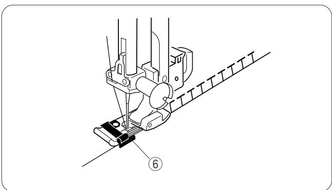
Этот стежок подходит для обработки срезов тканей стреч. Он одновременно делает шов и обрабатывает его.
